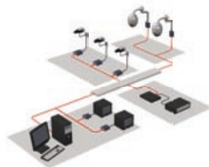
Configuration d'un système de vidéosurveillance IP
