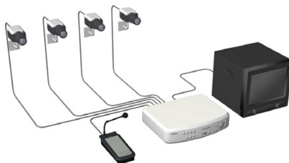
DVR4C avec quatre caméras, un microphone et un moniteur.
